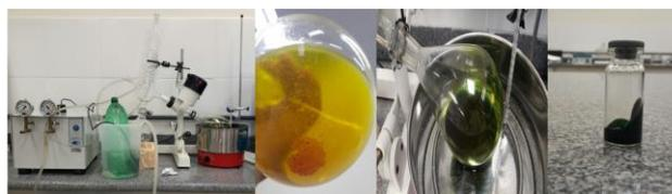
**Figura 2.** Procedimento para a obtenção dos extratos brutos a partir do uso do equipamento rota-evaporador.
